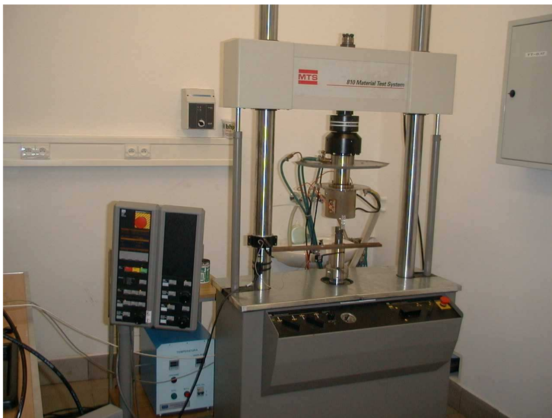
Fot.6 Maszyna wytrzymałościowa MTS 810 ( T_{\max}=1400^{\circ}\text{C} , F_{\max}=100\text{kN} )
