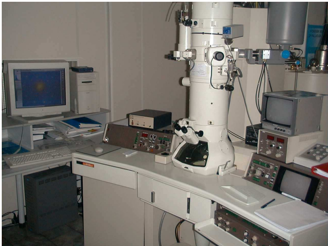
Fot.3 Wysokorozdzielczy elektronowy mikroskop transmisyjny JEOL JEM 3010 (300kV, rozdzielczość 0,19nm) wyposażony w przystawkę EDS do analizy składu chemicznego nanoobszarów
